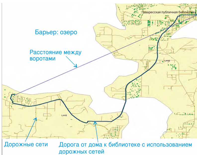
Рисунок 5. Сравнение методов измерения расстояния в пути (расстояния Эвклида и Манхэттена)
